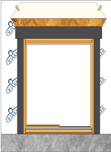
Aplica una capa de 3/8" de sellante en el borde externo del marco de la puerta antes de instalar el borde de goteo. Aplica impermeabilizante sobre la pata del borde de goteo, superponiendo el lado como se muestra en la imagen. Alisa usando un bolillo "J".
