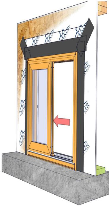
Desliza el panel apretando contra el marco manteniendo el tablero del panel con la extrusión del panel fijo en el alféizar.
