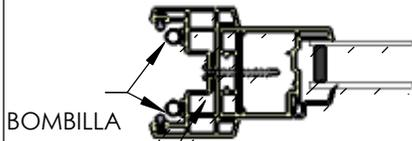
Taladra orificios de montaje por la moldura 2 1/2" de cada extremo y aproximadamente 12" en el centro. Evita poner sujetadores de montaje cerca del mango porque interferirá con la cerradura.
