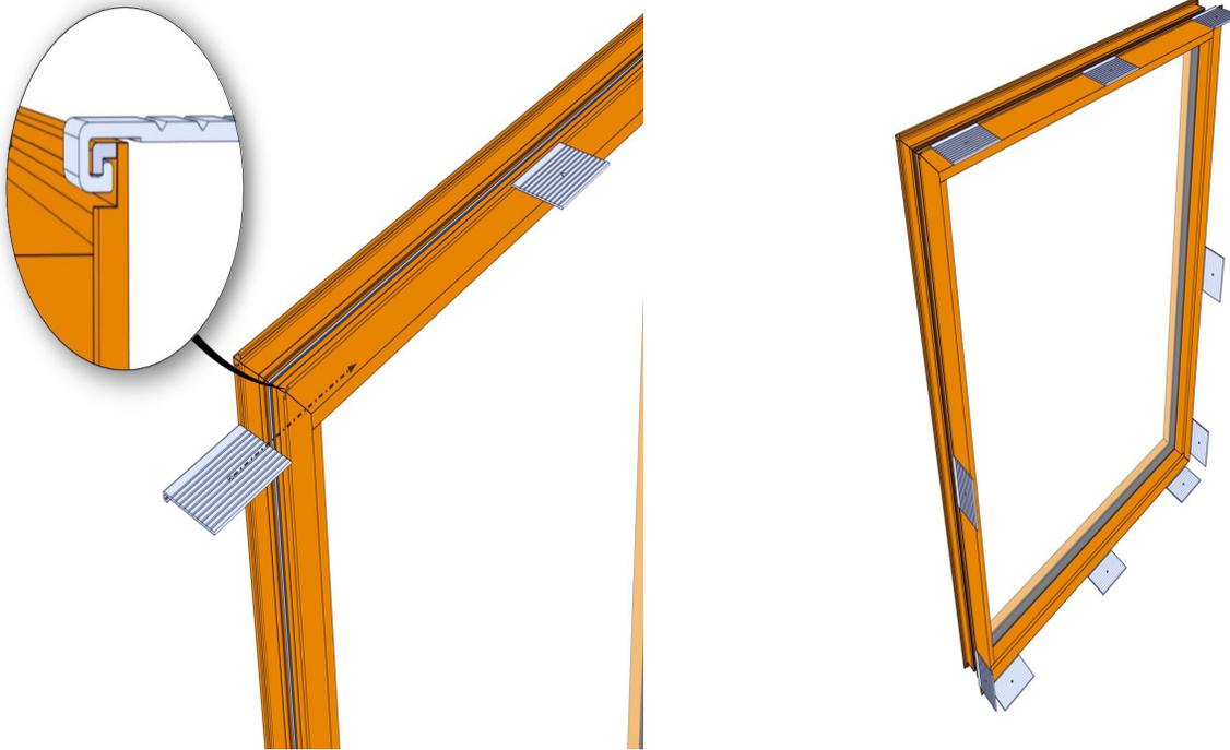
Desliza las correas de anclaje en el interior de la pata C de los marcos de la ventana como se indica en la imagen. Coloca la cinta de fijación alrededor del perímetro completo de la ventana posicionando como se indica en los planos técnicos o cálculos de anclaje, normalmente 3" desde las esquinas y 12" en el centro.
