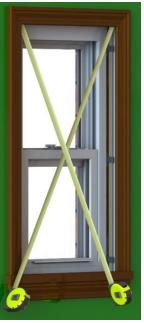
Revisa la instalación, nivel, cuadre, y funcionamiento de la ventana. Haz todos los ajustes necesarios a las cuñas y tornillos de los marcos acabados. Sube el panel inferior para instalar los tornillos inferiores, e inclina el panel inferior para instalar los tornillos del centro.
