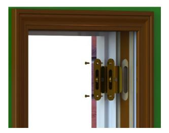
Baja el borde superior de la faja y corta los cordones de balance. Remueve la faja superior y deséchala o recíclala apropiadamente. Remueve los cordones de balance de las poleas. Remueve cualquier restante de material de la jamba (si aplica). Aisla los enrolladores y las aperturas o cualquier vacío.
