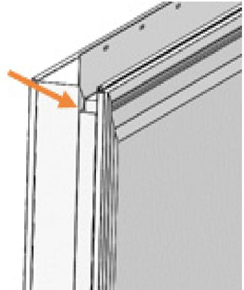
Instala el canal J en el embudo en el agujero del canal J en los lados a ser instalados del exterior de cada ventana. Corta el embudo corto de la cabecera y el alféizar del canal J de tal manera que no obstruya el canal.
