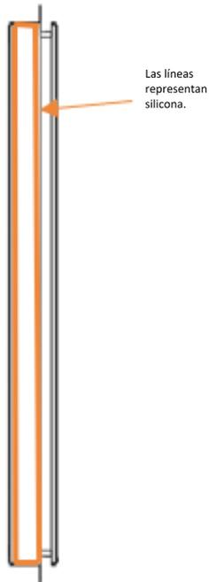
Aplica una capa continua de silicona en el todo el lado de las dos ventanas a ser instaladas.
