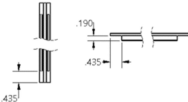
Corta las llaves del parteluz en C a la extensión de la unidad (ancho o largo) a ser instalado.
