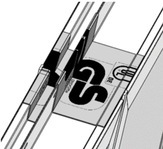
Aplica cinta impermeabilizante auto adherente sobre el borde superior de los espacios del parteluz y sobre la aleta clavada.
