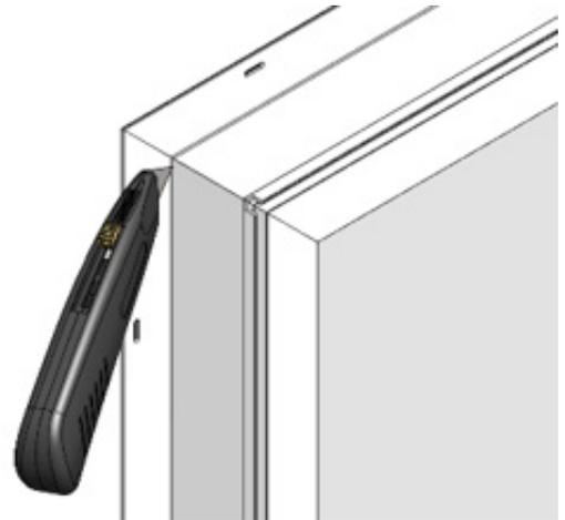
Utilizando una cuchilla multiuso remueve todas las aletas clavadas de cada unidad donde el parteluz se conecta con ellas. Asegúrate de cortar la cabecera y alféizar de las aletas clavadas hacia atrás con aletas clavadas rajadas.
