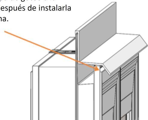
Instala la tapa de goteo sobre la aleta clavada en todo el largo de las unidades a ser instaladas. Muesca los terminales de la tapa de goteo de ser necesario de acuerdo a los estándares de instalación del canal J.
