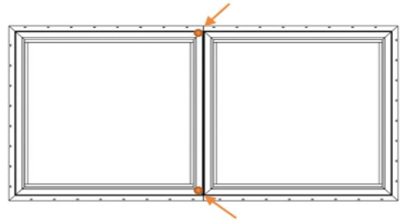
Ubica las ventanas juntas y añade una pequeña cantidad de sellante en la parte superior e inferior del canal del parteluz antes de accionar las llaves del parteluz.
