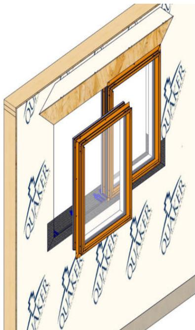
Instale la siguiente unidad de ventana en su lugar siguiendo la guía de instalación de aletas clavadas estándar de QWP. Asegúrese de que la unidad no tiene una aleta clavada en el lado de la unidad donde irá la montura. Asegúrese de dejar el espacio de 1" entre las unidades para permitir la montura en T.
