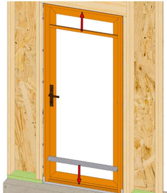
Instale las tapas de las jambas, luego la tapa del cabezal y el alféizar.
