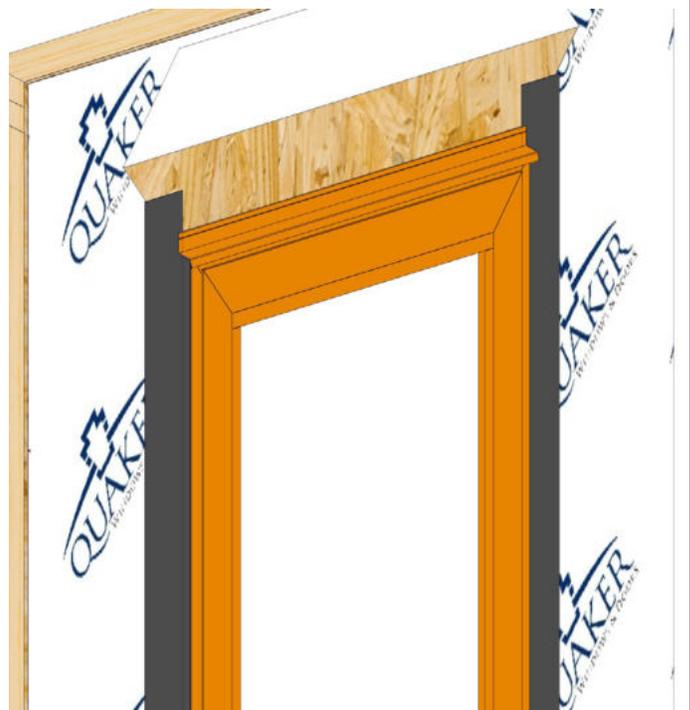
Coloque la tapa de goteo a todo lo ancho en el sellador como se muestra.
