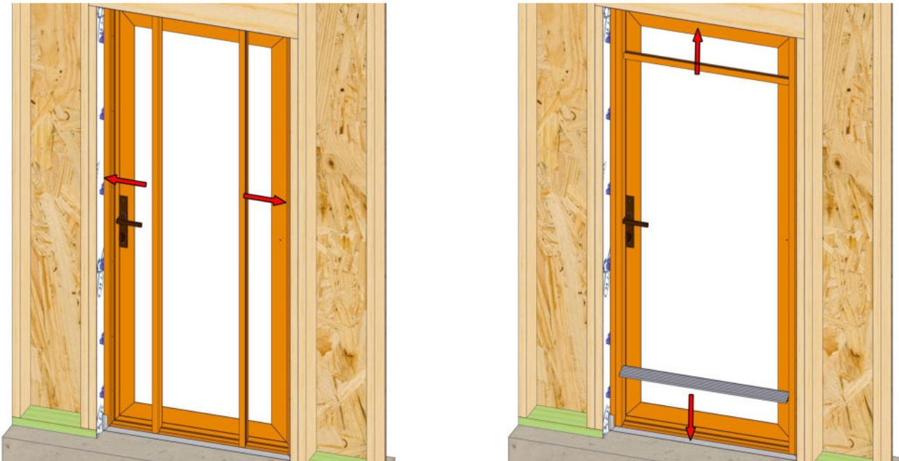
Instale las tapas de las jambas, luego la tapa del cabezal y el alféizar.
