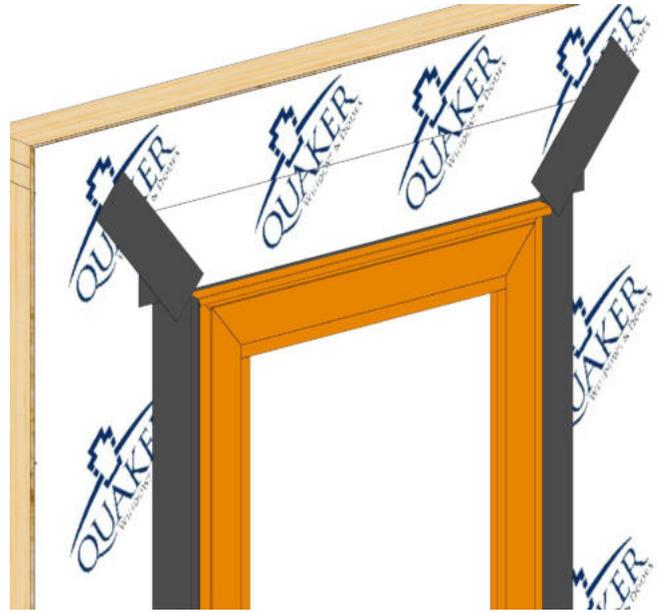
Baje la solapa superior de la barrera resistente a la intemperie para que quede plana sobre el tapajuntas y pegue los cortes en ángulo como se muestra arriba.
