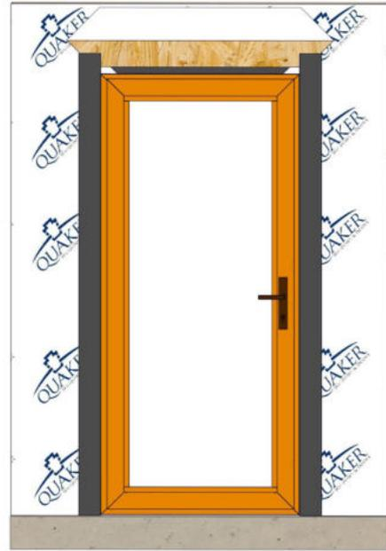
Corte dos trozos de cinta tapajuntas para el tapajuntas de la jamba que se extienden 1" por encima de la aleta de posicionamiento de la cabeza. Aplique la cinta de tapajuntas y alísela con un rodillo en J.
