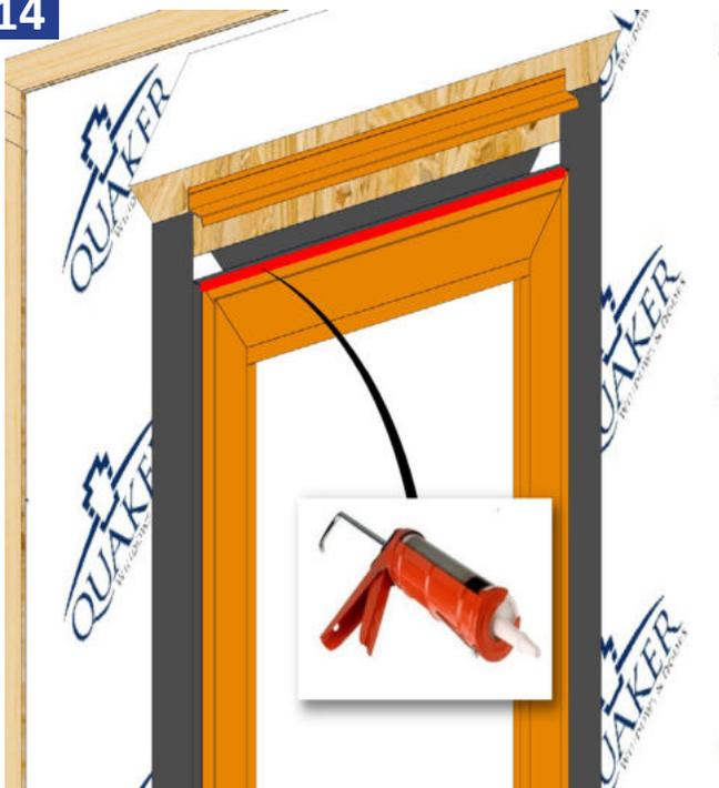
Aplique un cordón de sellador de 3/8" en el borde exterior superior del marco de la puerta antes de instalar la tapa de goteo como se muestra.
