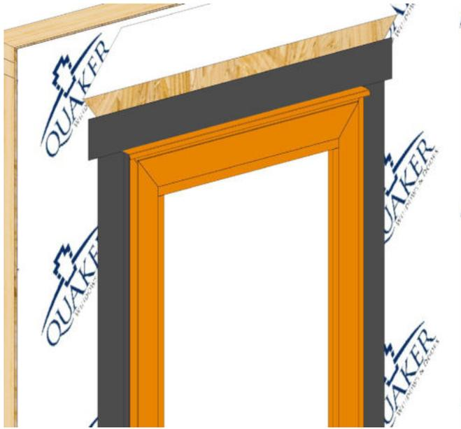
Aplique la cinta de tapajuntas sobre la pata de la tapa de goteo, solapando el tapajuntas lateral como se muestra. Alise con un rodillo en J.
