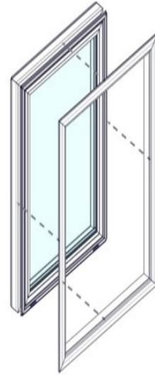
Desliza la aleta rasante soldada sobre el exterior de la unidad. Asegúrate de que el revestimiento se encuentre ajustado hacia el exterior de la pata en C.
