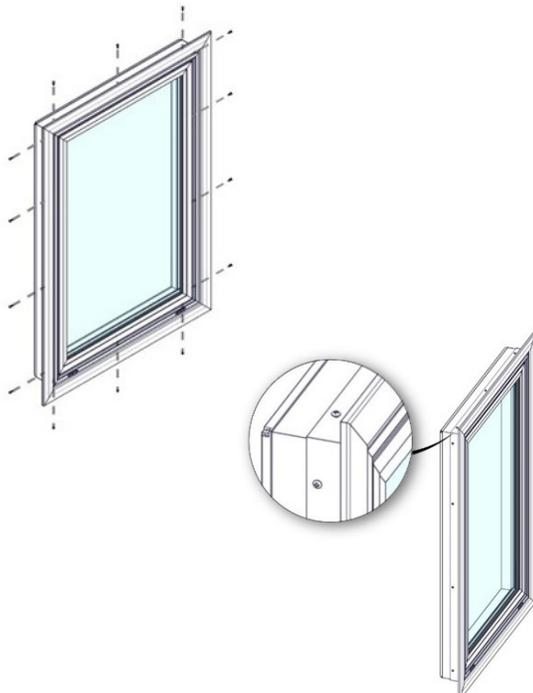
Atornilla la aleta rasante a la unidad usando los tornillos provistos. Ubica tornillos de 2" desde cada terminal y de 8" en el centro. Mantén los tornillos en el lado interior del revestimiento de la aleta rasante.
