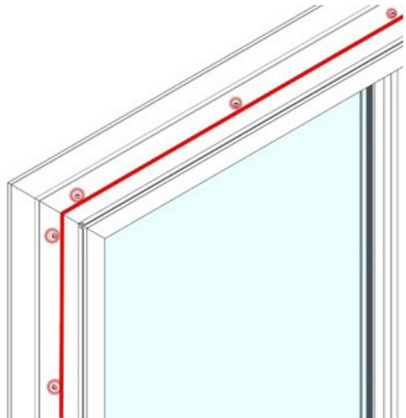
Aplica sellante a lo largo de todo el borde del revestimiento de aleta rasante contra el lado interior de la unidad y en cada cabeza de tornillo. Instala la unidad a través de cada jamba de la ventana de acuerdo al manual de instalación.
