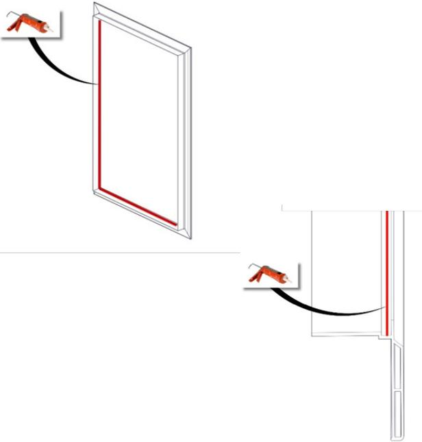
Remueve todas las aletas clavadas si no han sido removidas de fábrica. Aplica una capa continua de sellante alrededor de los cuatro lados del revestimiento de la aleta rasante.
